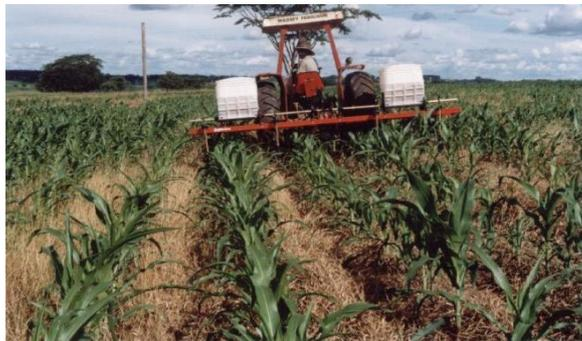
**Figura 3.** Adubadora de cobertura com disco de corte, próprio para o plantio direto.
