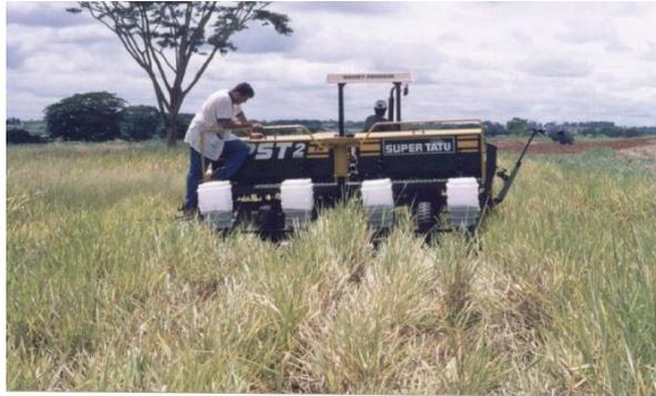
**Figura 2.** Semeadora para plantio direto com marcador de linha com disco de corte.
